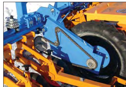
Verstellbare Laufradwange für Damm- und Beetsaat
