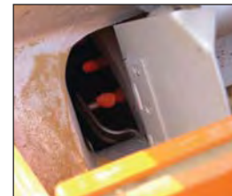
Kornselektion mit Doppelabstreifer
