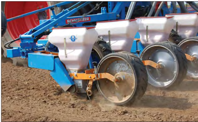
P4000 mit Schneidscheiben und großer Andruckrolle 500 mm
