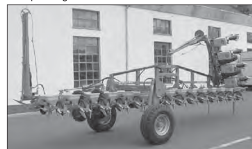
Transportwagen mit hydr. Radaushub
