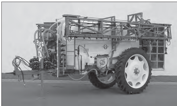
ASP 5 600 I - 280 l - 30 m Hydrantenanschluss für Tank und Spülanlage Die Bedieneinheit, Handwaschbehälter und Einspülschleuse bequem erreichbar
